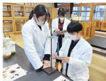
自作の強度測定器で焼酎粕ポリ乳酸プラスチックの強度を測る様子
