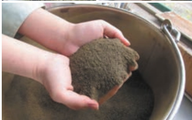
海藻アカモクの残さと竹を乾燥させパウダー状に加工する。
