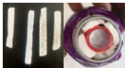
加工した発泡ポリスチレンは、空き缶の中に拍子木状に詰められ固体燃料となる。
