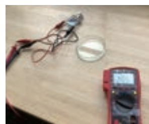
作成した色素液を使い発電量を計測
