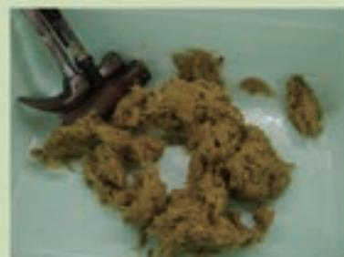
す。それをさらに5mm程度の大きさにカットした後、水と一緒にミキサーにかけていきます。こうしてできた紙料を漉いて、乾燥させて作ります。
