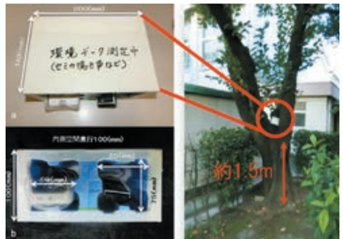
都内を1人で駆け回り、セミの鳴き声を録音するICレコーダーと環境データ観測装置を設置。回収、分析まで行った。
