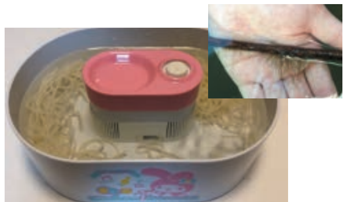
家庭用流しそうめん機をヒントに、オオイシソウに必要な水流を身近な素材で再現した培養装置。右上は野生のインドオオイシソウ。
