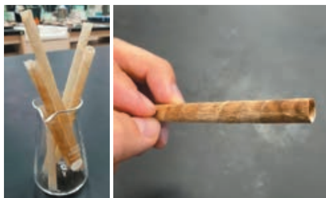
酢こんにゃくから作成したBC (バクテリアセルロース) ストロー。
