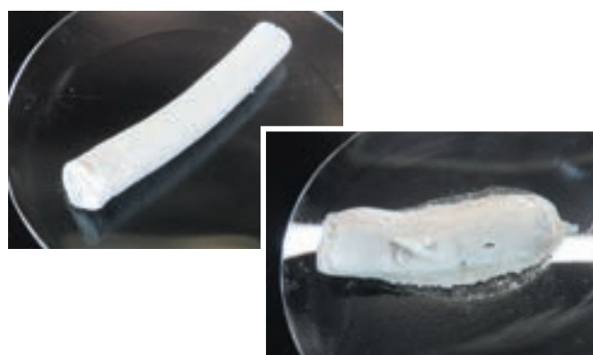
適切な強度をもち実用に向けた、乾燥剤を用いたリサイクルチョーク。(上) 十分に固まらず手に持てなかった、卵の殻を用いたリサイクルチョーク。(下)
